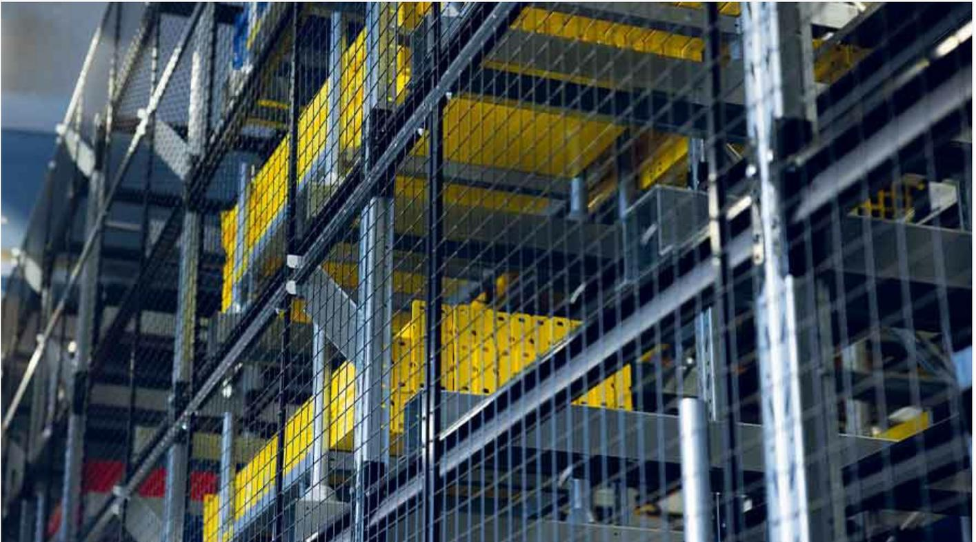
Stützenverlängerungen werden als Zubehör angeboten. Hierdurch ist es möglich, den Fallschutz höher als die bestehenden Regalstützen zu montieren.
